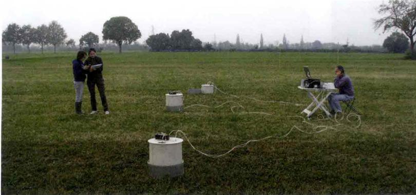
**3. Camere statiche collegate ad analizzatore per la misura delle emissioni di protossido di azoto dal suolo.**
