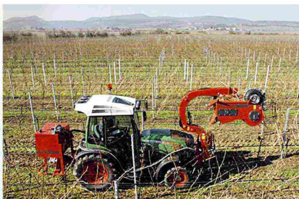
Foto 3 Due modelli di macchine con dischi controrotanti che intercettano il legno reciso per convogliarlo verso la testa di triturazione. I residui vengono poi dispersi al centro della fila
